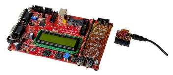
**I-jet** はインサーキットデバッグプローブで、チップの JTAG/SWD ポートを USB 経由でホスト PC に接続します。I-jet は IAR Embedded Workbench に統合されており、プラグアンドプレイの互換性があります。
